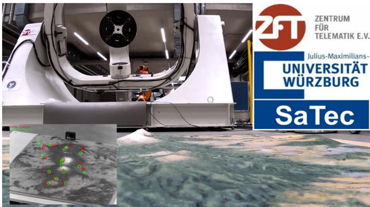
Hardware-in-the-Loop-Umgebung mit dem Drehtisch, verfolgte Features, Beobachtungsziel mit dem Vulkan und beteiligte Partner
