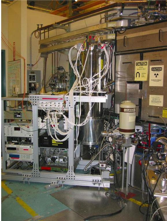
Photo der LLNL SuperEBIT Hochenergie-Elektronenstrahl-Ionenfalle und dem NASA/GSFC EBIT Kalorimeter Spektrometer.
